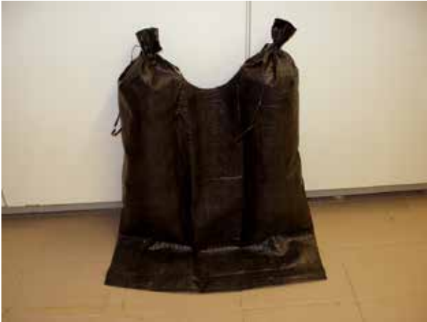
Abb. 7-19 Tandemsack leer, befüllt (Fotos: Alois Bamert, alba Feuerwehrtechnik)
