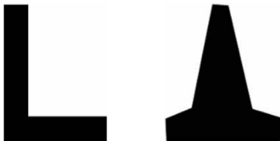
Abb. 7-21 Konstruktionsformen von Masselementen (nach Egli, 2004]
