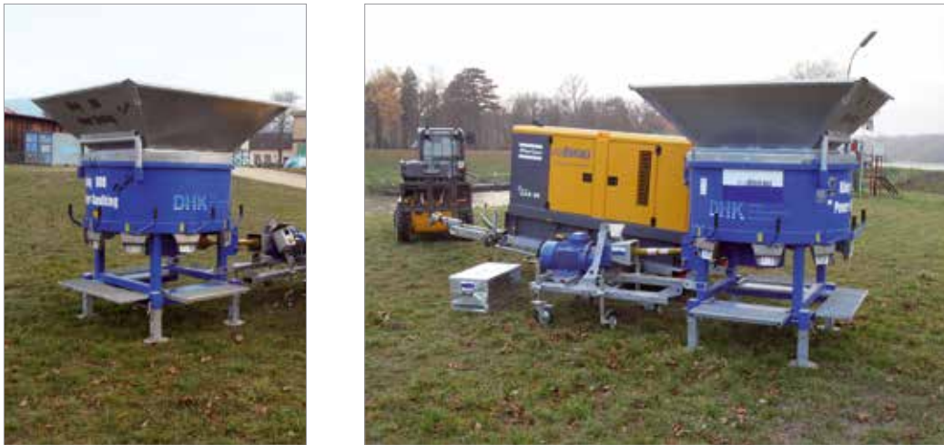
Abb. 7-18 Sandsackbefüllmaschine der Donauhochwasserschutzkonkurrenz (DHK) (Fotos: DHK)
